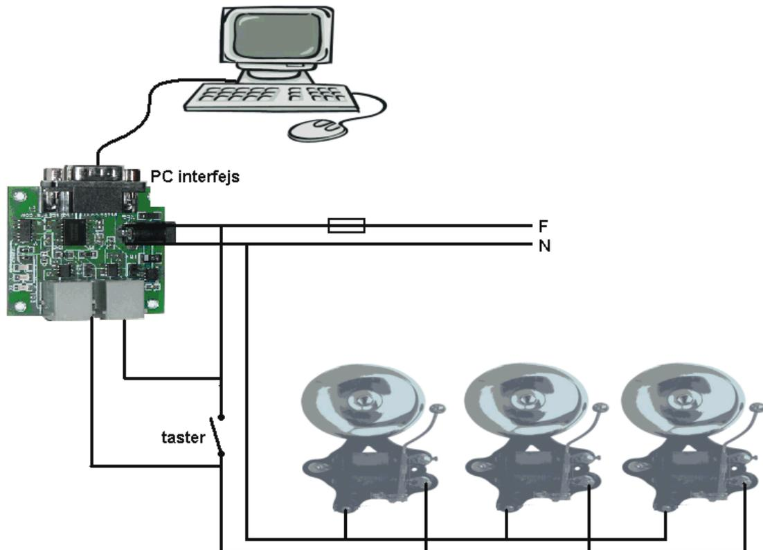
Kao što je prikazano na semi uređaj se spaja na mrežu 220V, preko koje dobija napajanje. Kontakti relea se spajaju paralelno postojećem tasteru za zvono. I kabal za povezivanje sa racunarom se ukljuci u racunar.
