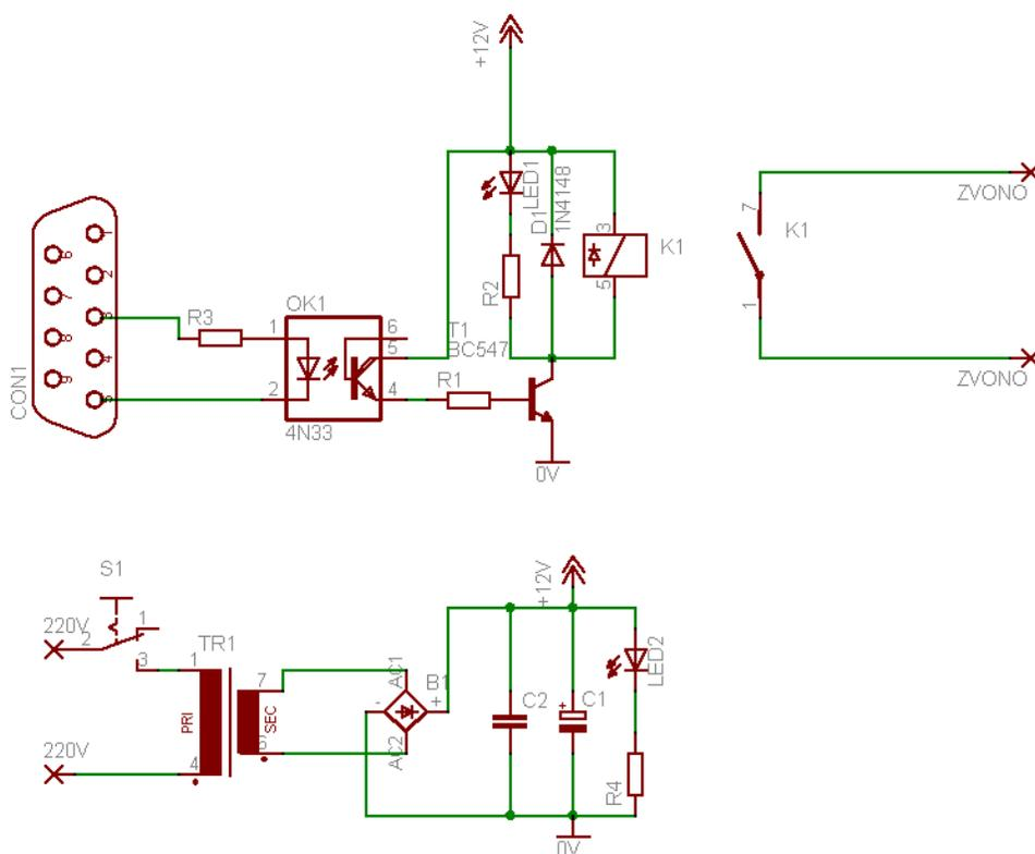
Na donjem delu seme jetransformator i ispravljac koji služi da obezbedi napon za napajanje uređaja. Sklopkom S1 se uključuje i isključuje uređaj. Led 2 služi za indicaciju napajanja uređaja.
