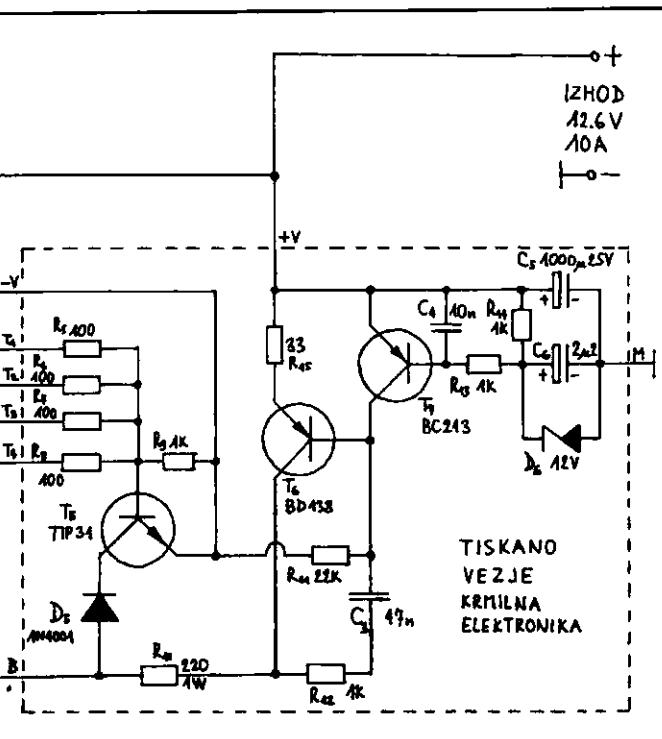
Slika 4 - Načrt napajalnika 12V / 10A.
