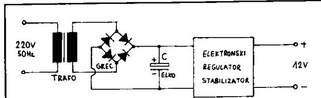
Slika 1 - Napajalnik z usmernikom s kapacitivnim vhodom.
