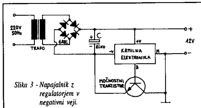
Slika 3 - Napajalnik z regulatorjem v negativni veji.
