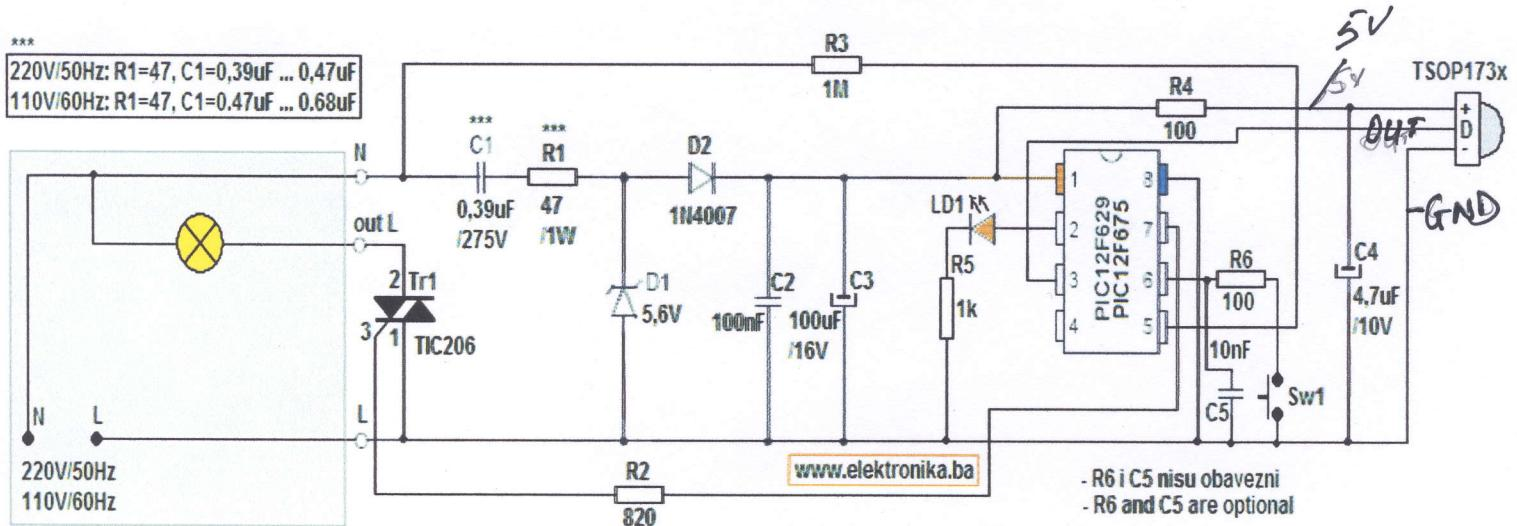
Na ovoj gore shemi, ako se TSOP postavi kao na slici gotovog uređaja Out ide preko R4 (100Ω ) na pin 1, Gnd ide direktno na pin 3, a Va 5v na fazu (L), jer je prva na TSOP 1738 i 1138, izlazi isti. Prvi Gnd, drugi Va 5v, trči Out i tako postavljeno na pločicu, ako se ne križaju nogice , čini mi se spojevi su kako sam napisao.
