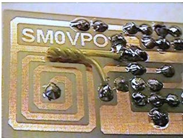
Na slici se vidi dodatak tkz. "gimmick" kondenzator dodan paralelno kondenzatoru 12pF za podešavanje frekvencije, kojim se smanjuje frekvencija predajnika. Kondenzator se napravi tako da se međusobno spiralno upletu dvije izolirane žice duljine 2 cm. Time se frekvencija predajnika pomakne na donji dio skale. Rezanjem žica na kraću duljinu frekvencija predajnika se poveća na željenu vrijednost. Ukoliko se "odreže" nekoliko kHz previše, tada se žice gimmick kondenzatora malo jače upletu.
