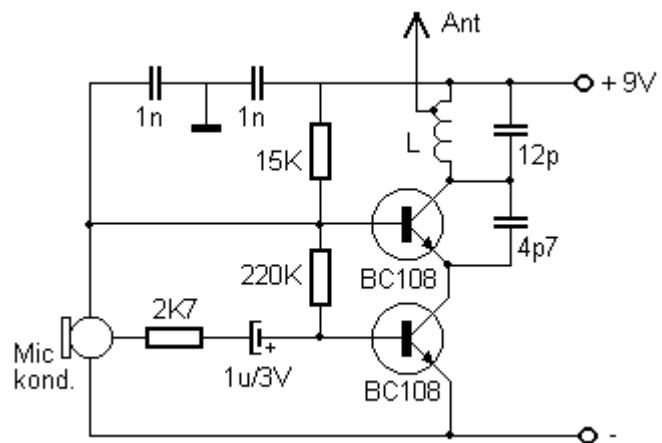
Ovaj predajnik radi na naponu napajanja od 9V i pokazao se kao odličan. Osim toga nema dijelova koje bi bilo teže nabaviti i izrađivan u više navrata nikad se nije desilo da nije iz prve proradio bez ikakvih podešavanja.
